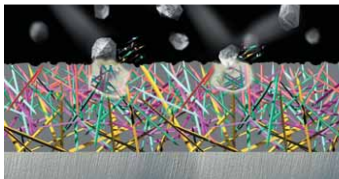
Стандартная структура наплавленного слоя со случайно ориентированными быстро выкрашивающимися твёрдыми фазами
