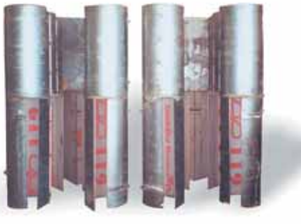
Трубы циклона в вентиляционной системе эксгаустера. Тепловая электростанция
